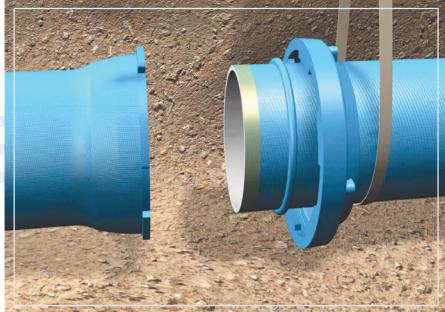
انتهای اسپیگات لوله را که رینگ قفل کننده بر روی آن در فاصله مناسبی جوشکاری شده است را به گونه ای که دو لوله در یک امتداد باشند - در صورت نیاز از یک گوه مناسب جهت قرارگیری در یک راستا استفاده شود - وارد سرکاسه لوله مقابله نمایید و با اعمال فشار یکنواخت ترجیحاً با ابزار مناسب از قبیل دیلم یا وینچ های مکانیکی دو لوله را مونتاژ نمایید.
